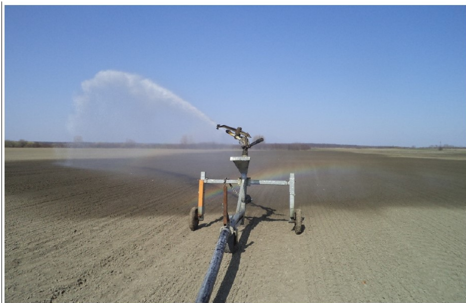
Slika 2. Kišenje površine samohodnom sektorskom prskalicom (Izvor: Glavni projekt – izgradnja bunara i navodnjavanja poljoprivrednih površina, 106/2022, TORZO d.o.o., Lovas, prosinac 2022.)
